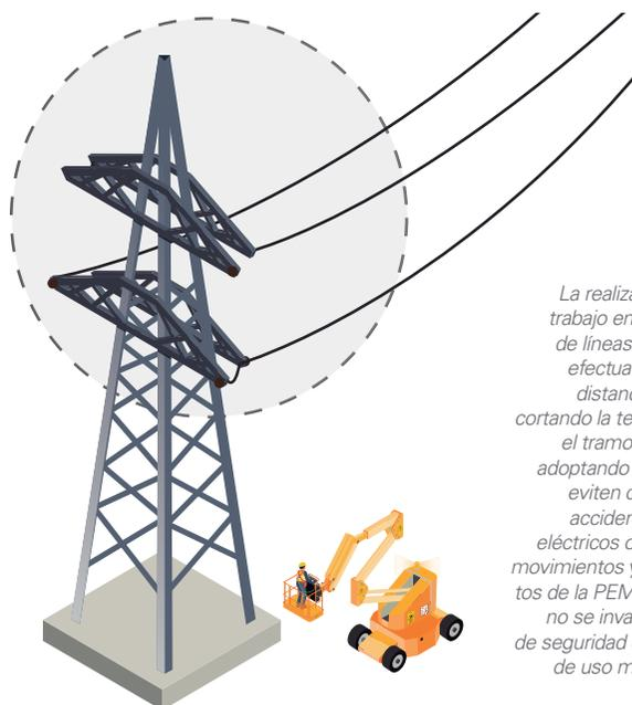
*La realización de cualquier trabajo en las proximidades de líneas eléctricas deberá efectuarse guardando las distancias de seguridad, cortando la tensión eléctrica en el tramo correspondiente, adoptando protecciones que eviten cualquier contacto accidental con los cables eléctricos o restringiendo los movimientos y/o desplazamientos de la PEMP, de manera que no se invadan las distancias de seguridad en las situaciones de uso más desfavorables.*
