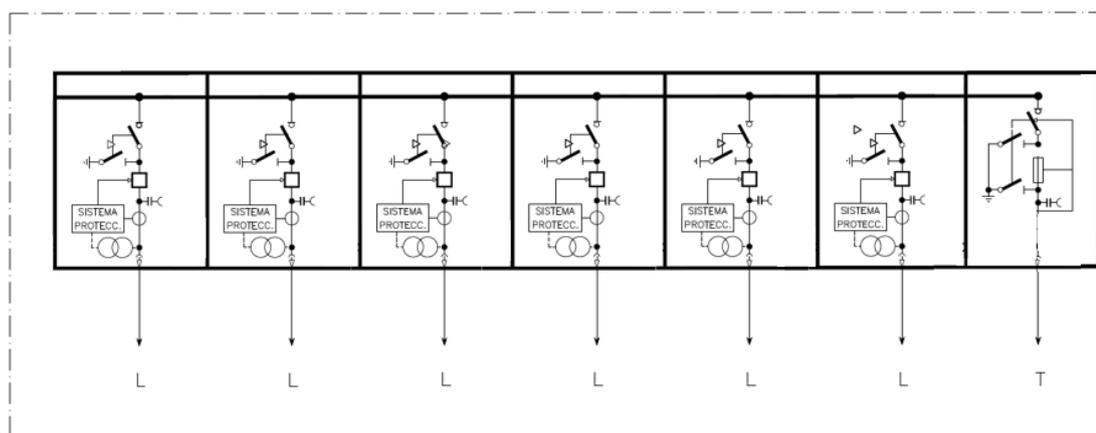
Esquema unifilar de centro de reparto con una línea de alimentación
