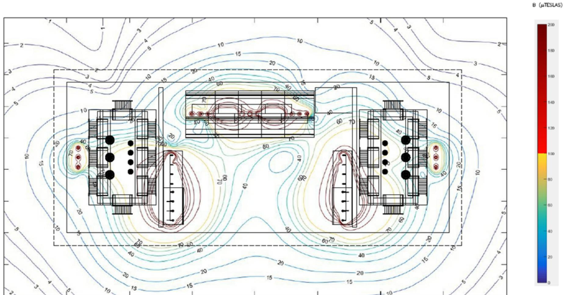
Campo magnético exterior 1 m sobre el suelo del CT y 0,2 m de la pared.
