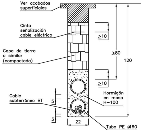
TUBO HORMIGONADO (con tubo de control)
