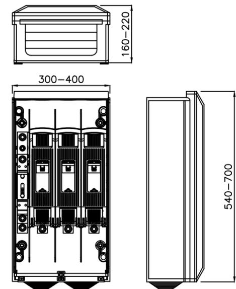
\* Cota mínima considerando caja y CGP de seccionamiento tipo ancho
