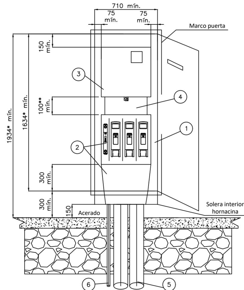
**CAJA SECCIONAMIENTO TIPO ANCHA**
