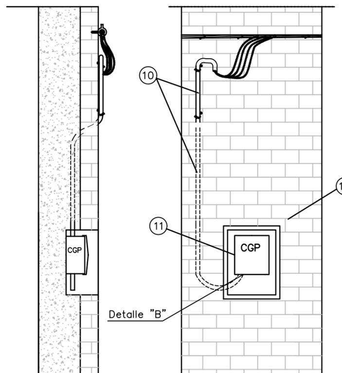
Canalización de la acometida bajo tubo (obligatoria su instalación en distancias inferiores a 2,50 m con respecto al nivel del suelo):
