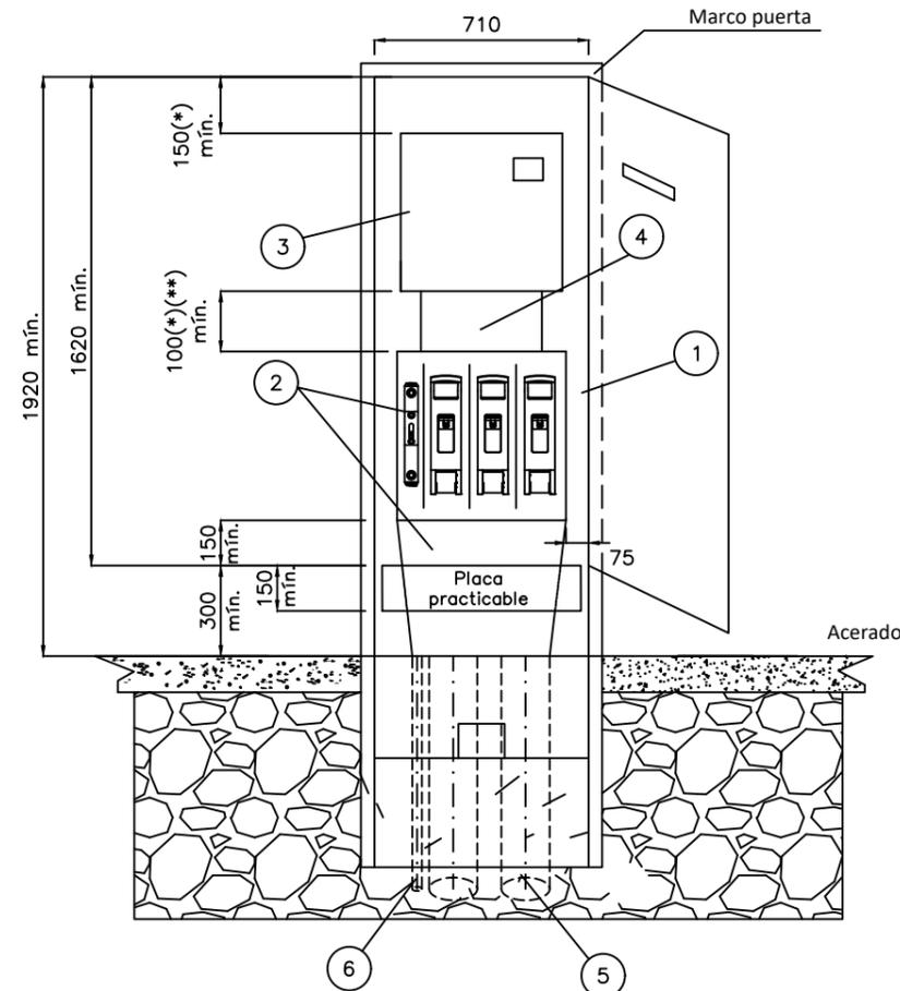
CAJA SECCIONAMIENTO TIPO ANCHA
