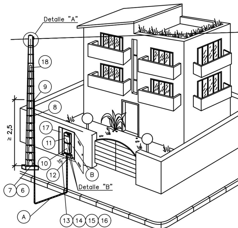
(A) Tramo de recorrido subterráneo hasta la caja de seccionamiento, igual tratamiento que una línea subterránea de BT.
