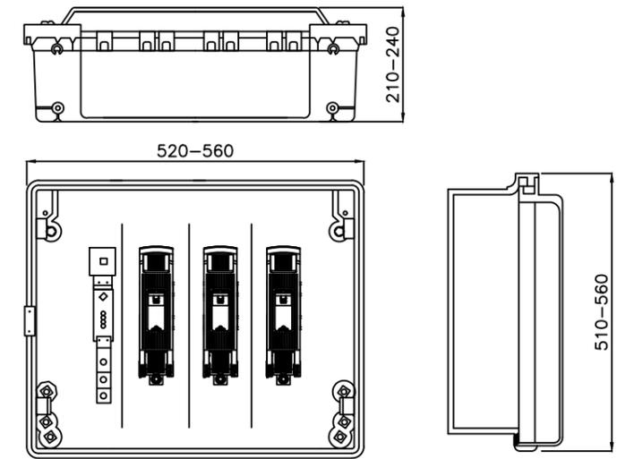
**CAJA SECCIONAMIENTO TIPO ESTRECHA**
