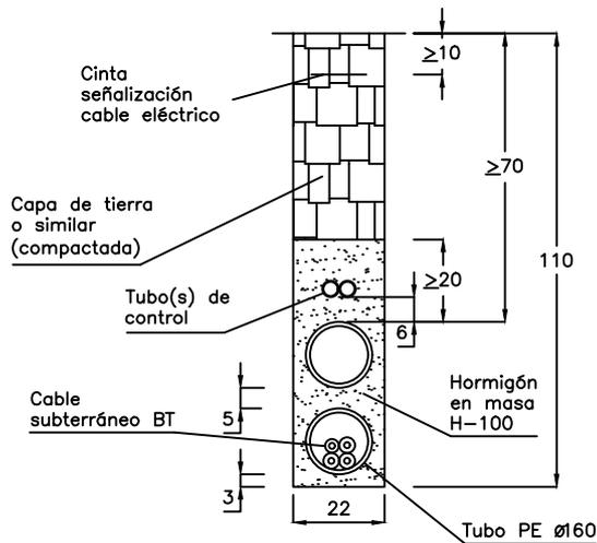
TUBO HORMIGONADO (con tubo de control)
