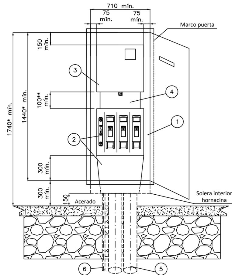
**CAJA SECCIONAMIENTO TIPO ANCHA**
