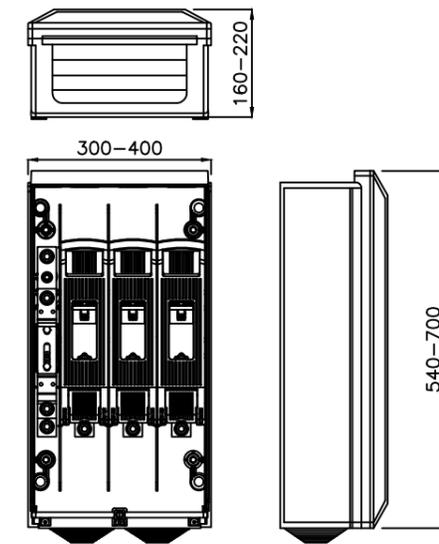
Caja de seccionamiento CS-400 acometida parte superior (tipo ancha) y canal de protección
