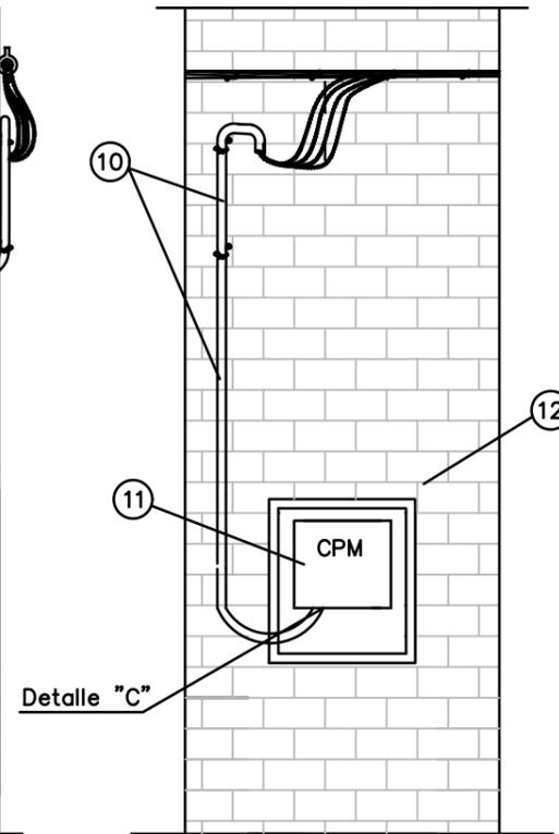
Canalización de la acometida bajo tubo (obligatoria su instalación en distancias inferiores a 2,50 m con respecto al nivel del suelo):
