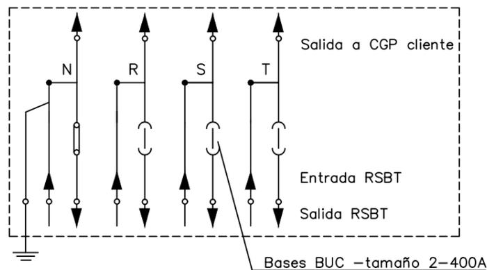
Caja de seccionamiento CS-400 acometida parte superior (tipo ancha) y canal de protección
