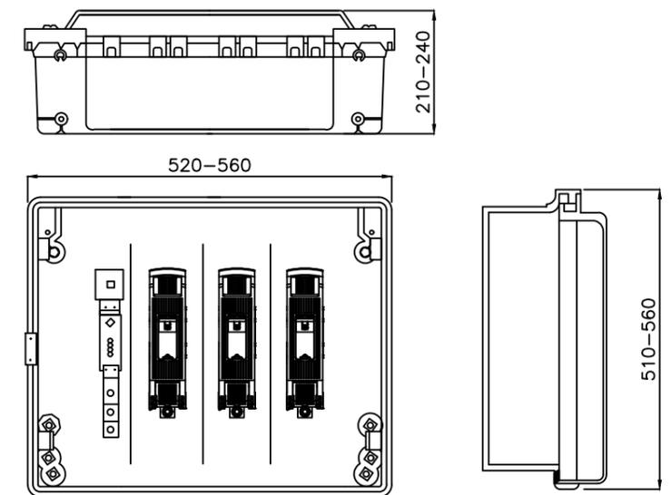
**CAJA SECCIONAMIENTO TIPO ESTRECHA**
