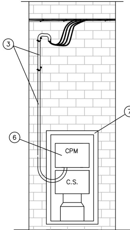
Canalización de la acometida bajo tubo (obligatoria su instalación en distancias inferiores a 2,50 m con respecto al nivel del suelo):
