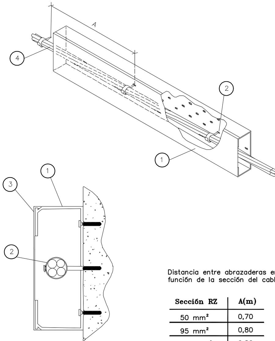
Distancia entre abrazaderas en función de la sección del cable RZ
