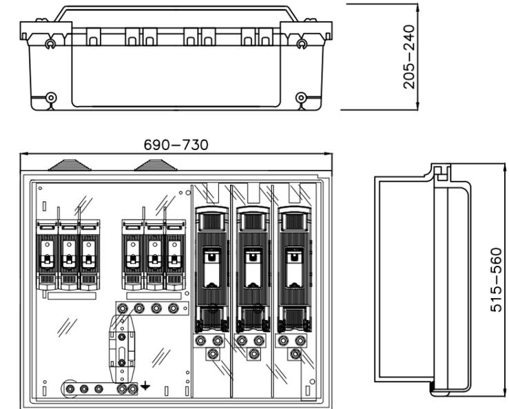
ESQUEMA CAJA SECCIONAMIENTO
