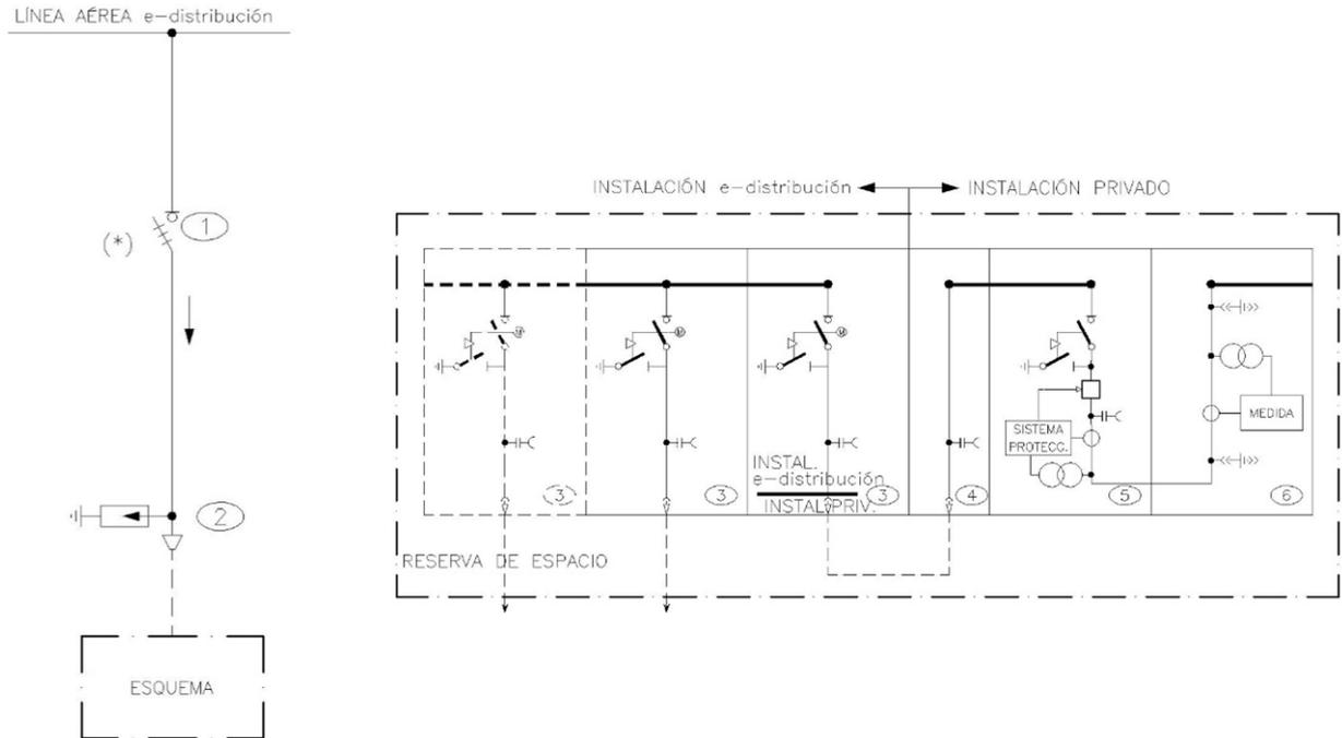
(\*) Se instalarán elementos de protección, asociados al elemento de seccionamiento, en aquellos casos en los que así lo indiquen las *Especificaciones Particulares para Instalaciones MT/BT de e-distribución* aprobadas.
