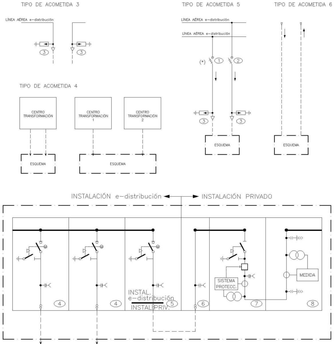
(\*) Se instalarán elementos de protección, asociados al elemento de seccionamiento, en aquellos casos en los que así lo indiquen las *Especificaciones Particulares para Instalaciones MT/BT* de e-distribución aprobadas.
