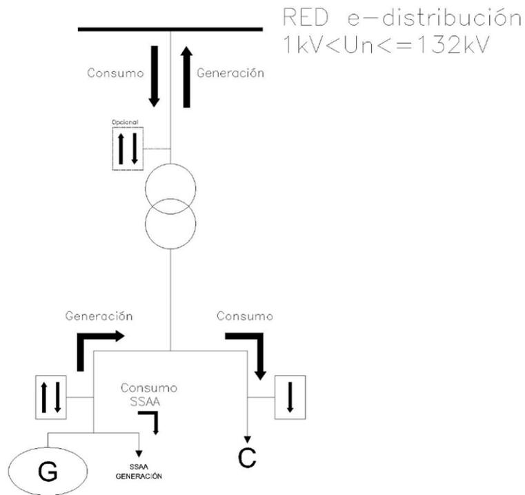
(\*) Este esquema también aplica para instalaciones de cogeneración que comparten la instalación de conexión con el consumo asociado y opten por vender toda su energía generada.
