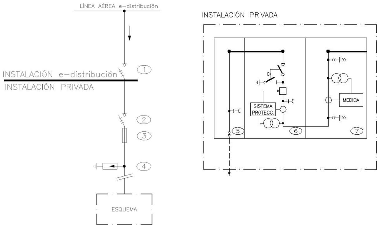
NOTA: En aquellas instalaciones donde se prevea una  $I_{cc} < 8 \text{ kA}$  la función de protección (elemento 3) podrá realizarse con cortacircuitos fusibles de expulsión (colocados *aguas abajo* del interruptor seccionador tripolar).
