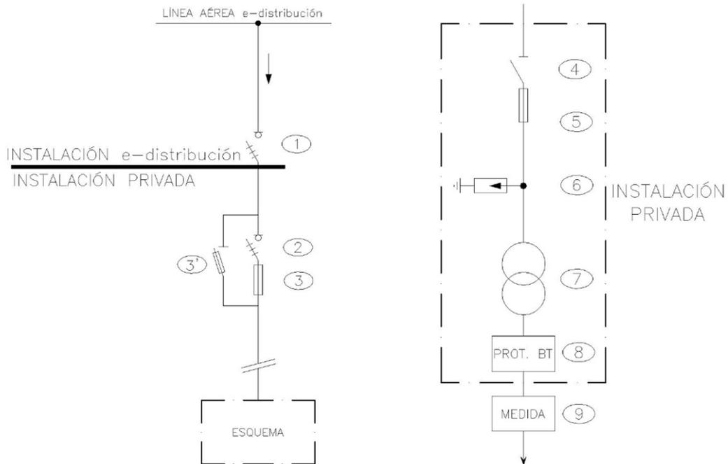
NOTA 1: Los dispositivos de seccionamiento y protección del transformador (4 y 5) podrán instalarse tanto en el propio apoyo del transformador como en su apoyo anterior. No serán necesarios en los casos en los que el transformador este en el primer o segundo apoyo de la derivación al hacer los dispositivos 2 y 3, ubicados en el primer apoyo, la función de seccionamiento y protección.
