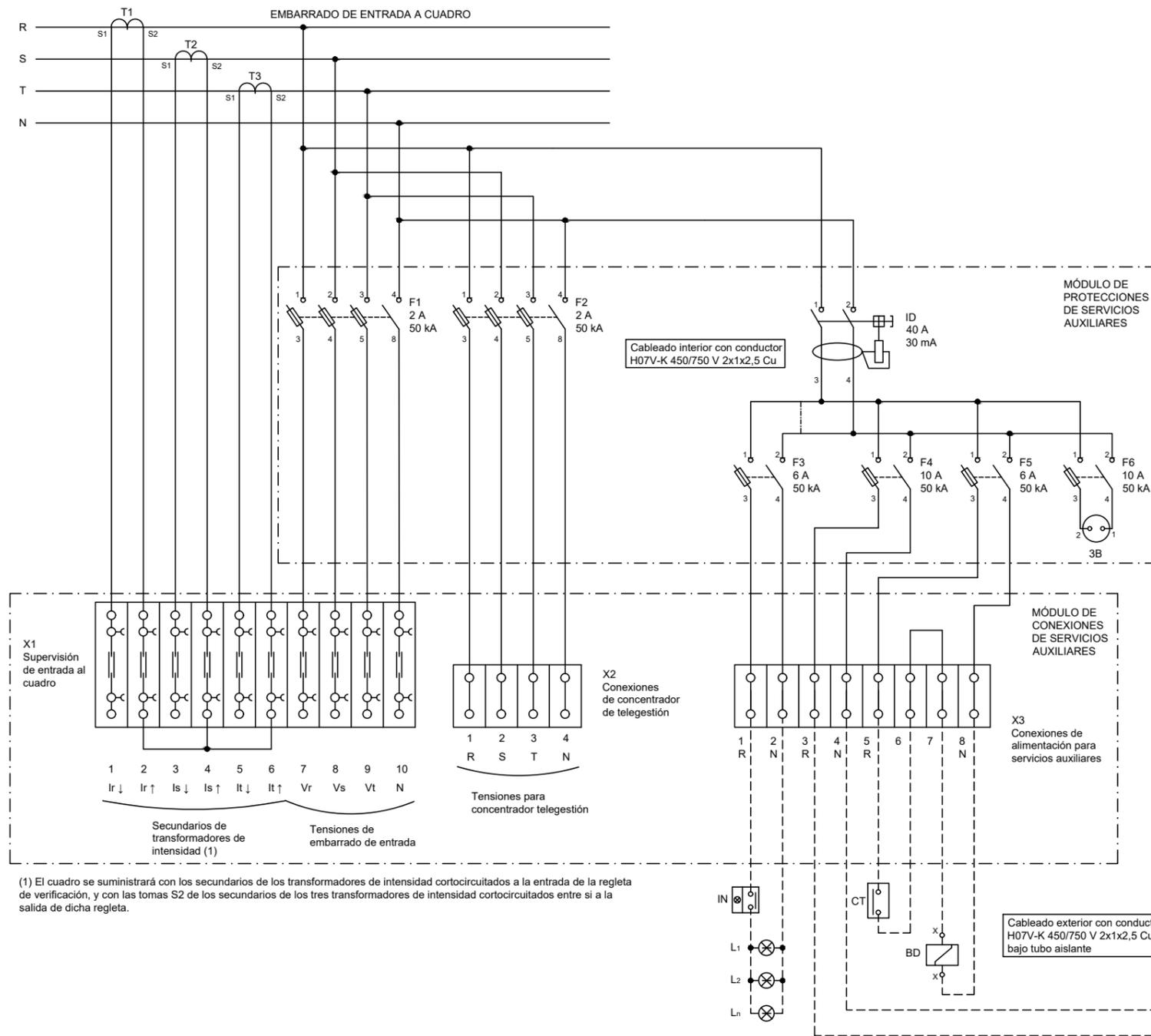
(1) El cuadro se suministrará con los secundarios de los transformadores de intensidad cortocircuitados a la entrada de la regleta de verificación, y con las tomas S2 de los secundarios de los tres transformadores de intensidad cortocircuitados entre sí a la salida de dicha regleta.
