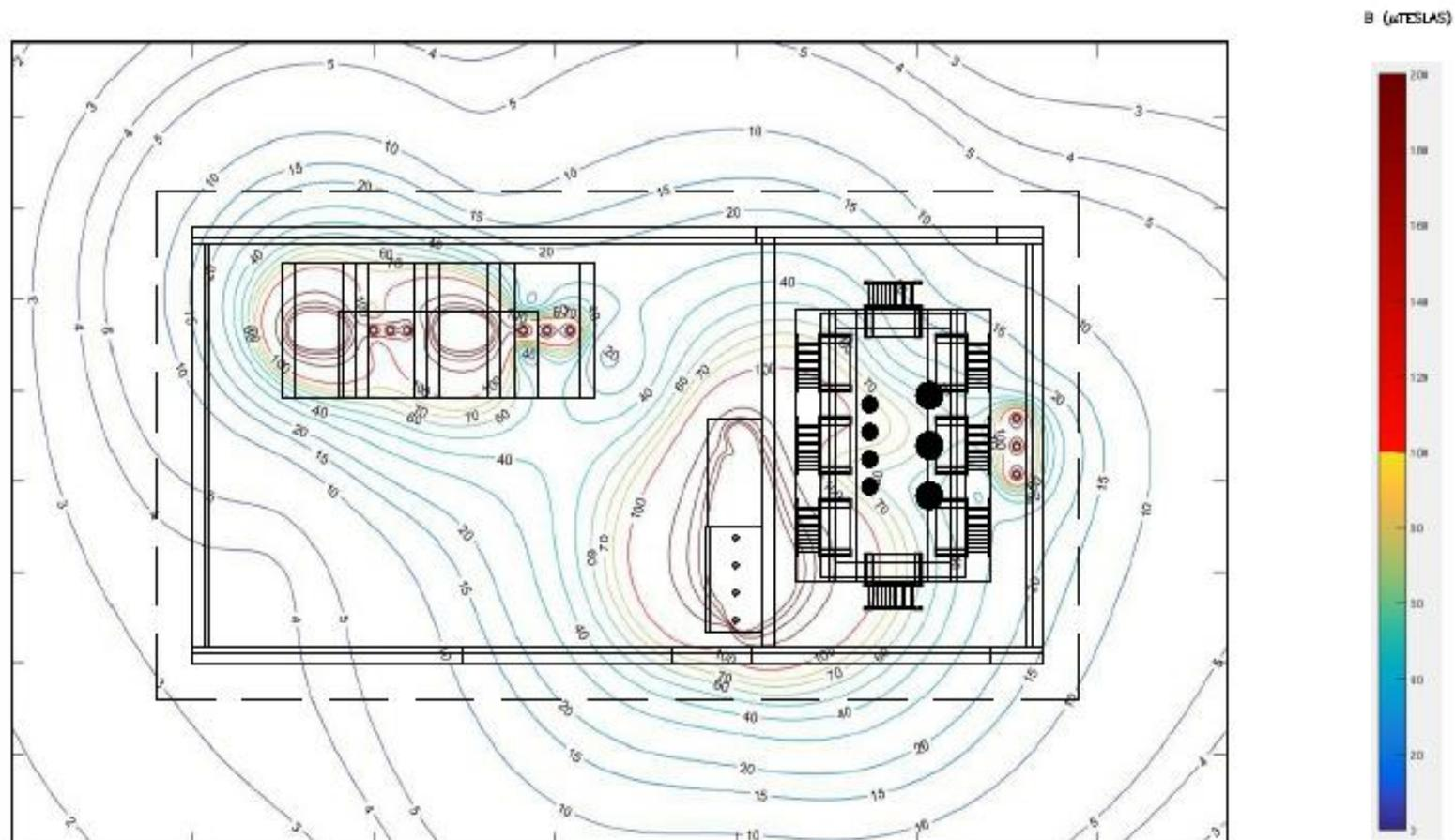
Campo magnético exterior 1 m sobre el suelo del CT y 0,2 m de la pared.
