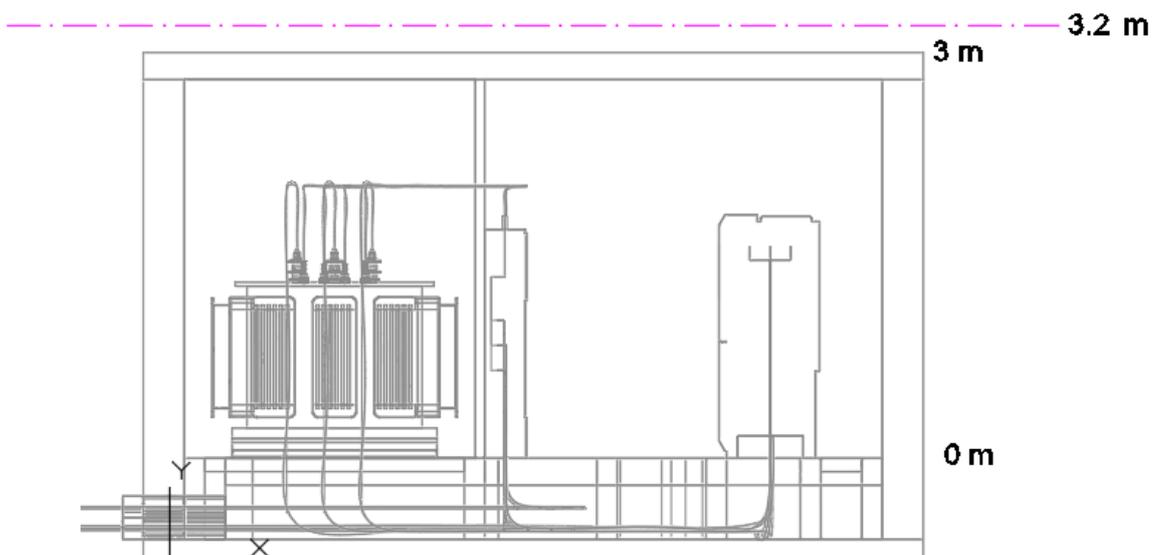
En este caso, los valores más elevados de campo, se producen sobre la zona de la salida de baja tensión del trafo, siendo de 31,33  $\mu\text{T}$ .
