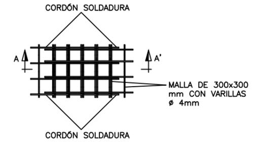
EL SOLAPE DE LAS MALLAS SE REALIZARÁ COMO MÍNIMO EN CUATRO CUADRÍCULAS, SIEMPRE QUE SEA POSIBLE. LA UNIÓN SE REALIZARÁ POR SOLDADURA ELÉCTRICA U OXICETILÉNICA Y COMO MÍNIMO EN DOS DE CADA CUATRO VARILLAS EN EL SENTIDO DEL SOLAPE.
