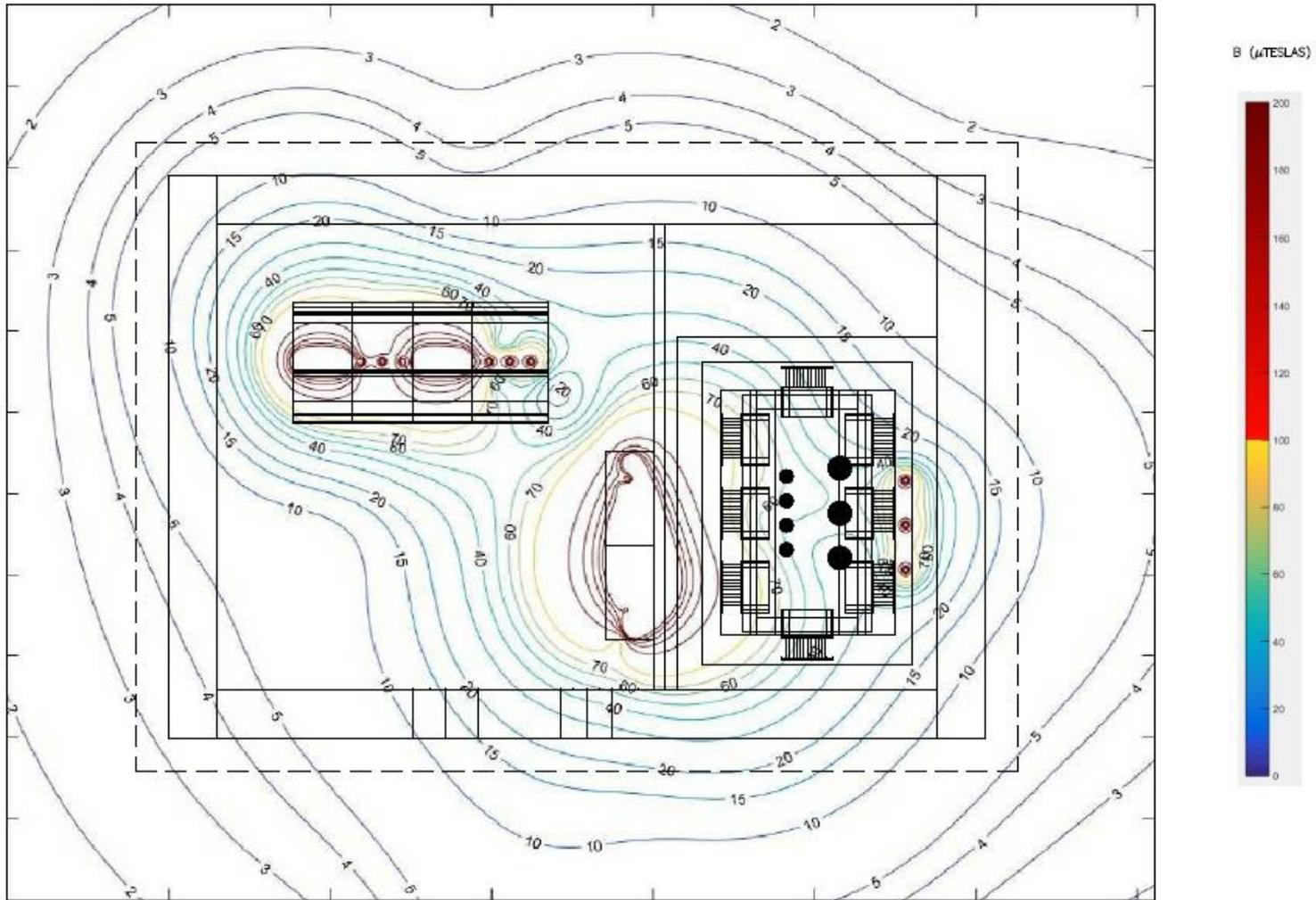
Campo magnético exterior 1 m sobre el suelo del CT y 0,2 m de la pared.
