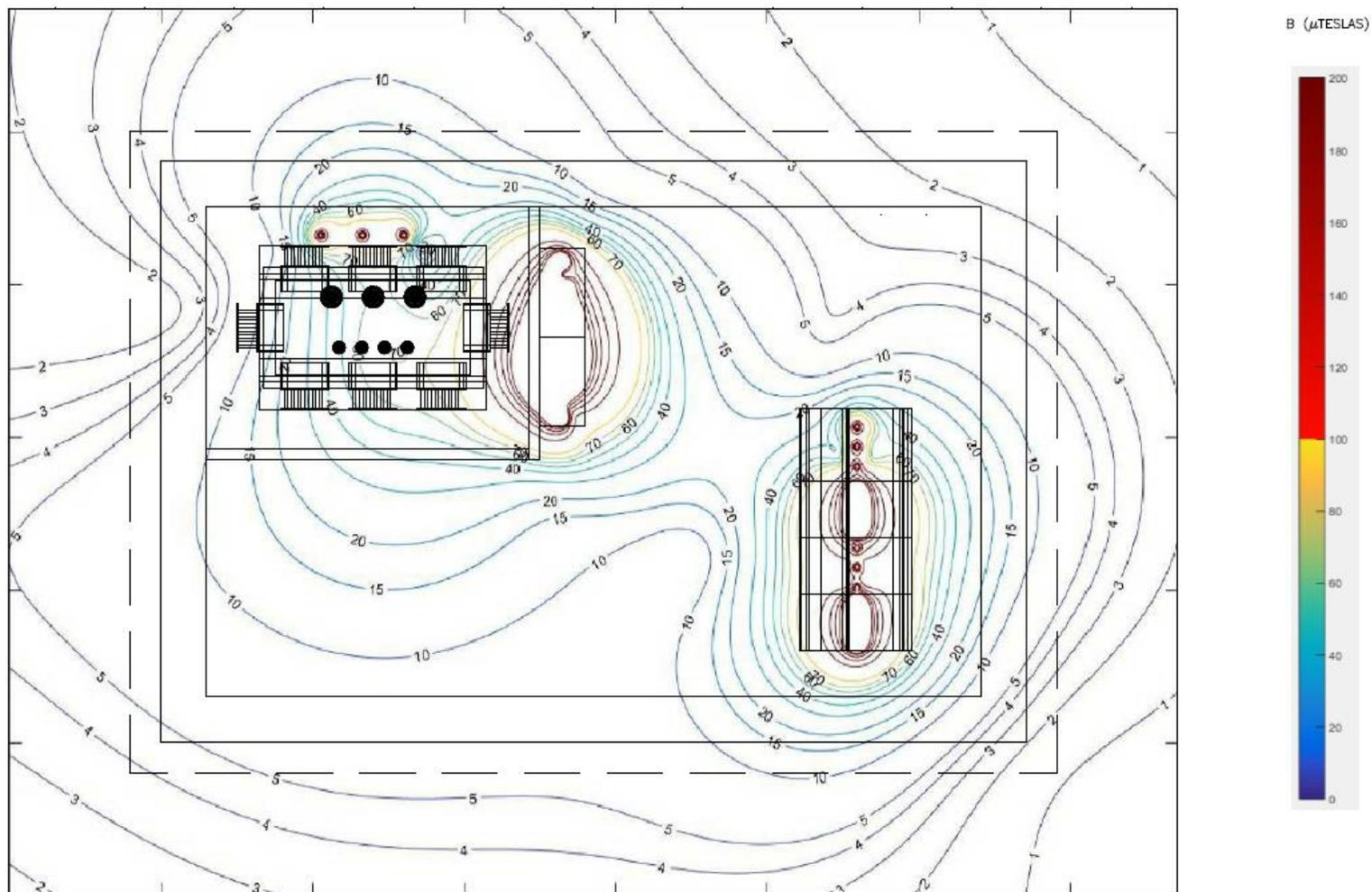
Campo magnético exterior 1 m sobre el suelo del CT y 0,2 m de la pared.
