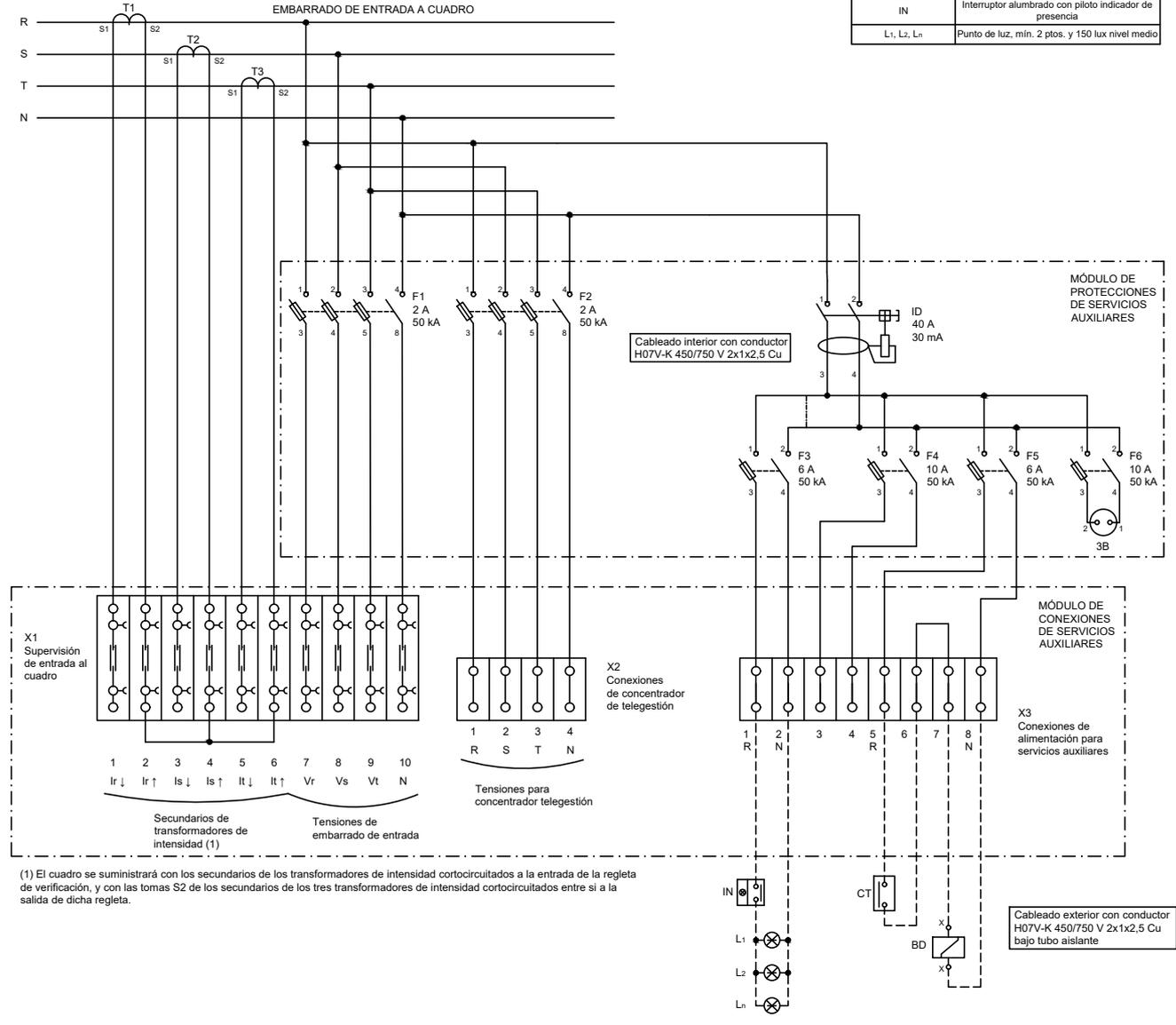
(1) El cuadro se suministrará con los secundarios de los transformadores de intensidad cortocircuitados a la entrada de la regleta de verificación, y con las tomas S2 de los secundarios de los tres transformadores de intensidad cortocircuitados entre sí a la salida de dicha regleta.
